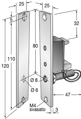
Sensore di prossimità da incasso per controllo accostamento porta. Tipo reed con magnete maggiorato, anche per porte tutto ferro (da installare sul lato superiore della porta per controllare lo stato "porta allineata").
