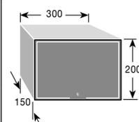
**ESECUZIONE IN ARMADIETTO METALLICO PICCOLO** da parete con portella avvitata. Vano porta batterie da 12 Vcc con capacità max 6Ah (oppure 2 x 1,9 Ah).
