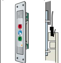
Semaforo SLIM-DUALUX No-touch tipologia 2 in tecnica "Click & Go" per incasso complanare "a filo piano" nel ribasso del pannello mediante flangia frontale (per es. da montare su pannello-parete adiacente al serramento sul montante del quale non sono realizzabili scassi).
