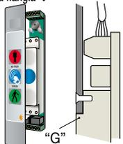
Semaforo SLIM-DUALUX No-touch tipologia 1 a complanarità totale a scomparsa. Per incasso "a filo piano" serramento senza flangia. Ideale per ottenere una superficie "liscia" (senza asperità) facilmente lavabile. Predisposto con schermo diffusore avente "gradino G" per profilati con spessore 1,6 mm. Completo di mascherina di copertura autoadesiva da applicare ad impianto ultimato.
