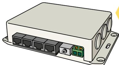
È l'interfaccia che gestisce il sistema di intercomunicazione parla-ascolta con ascolto e risposta alternata mediante modalità "push&call". In essa risiedono i circuiti di amplificazione e regolazione volume; controlla due canali A e B a cui devono essere collegati a ciascuno di essi una rispettiva unità parla-ascolta SLIM-DUALVOX.
