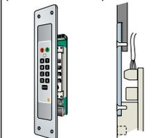
Tastiera a codice d'accesso SLIM-CODEGUARD tipologia 2 con flangia frontale per incasso a scomparsa "a filo" piano pannello (per es. pannello-parete adiacente al serramento sul montante del quale non sono realizzabili scassi).
