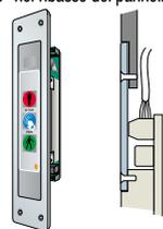
Semaforo SLIM-DUALUX No-touch tipologia 2 per incasso complanare "a filo piano" nel ribasso del pannello mediante flangia frontale (per es. da montare su pannello-parete adiacente al serramento sul montante del quale non sono realizzabili scassi). Completo di flangia frontale in alluminio anodizzato colore "argento" - 250x50 mm, spessore 2,5 mm per incasso "a filo" piano nel ribasso del pannello. Mascherina già inserita e fissata nella nicchia della flangia.
