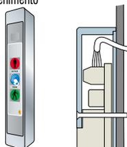
Semaforo SLIM-DUALUX No-touch tipologia 4 per montaggio in appoggio a superficie mediante custodia di contenimento. Completo di custodia protettiva extrarobusta, ricavata dal pieno in alluminio anodizzato colore "argento" (dim. 35 x 25 x 215 mm). Mascherina autoadesiva separata a parte da utilizzare come copertura finale per nascondere le 4 viti di fissaggio della custodia sul serramento.
