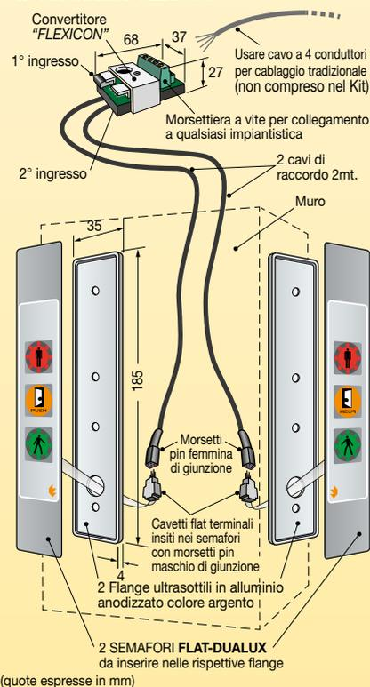
Gruppo semaforico con flangia di supporto ultrasottili (solo 4mm.) per montaggio "a filo piano" su superfici irregolari come intonaco, cartongesso, cemento, travertino o legno, ecc. È una "sottile piastra" elettronica applicabile a parete (su qualsiasi superficie) con 4 piccole viti. Dotato di convertitore FX con morsettiere a vite per collegamento a qualsiasi centralina di gestione.
