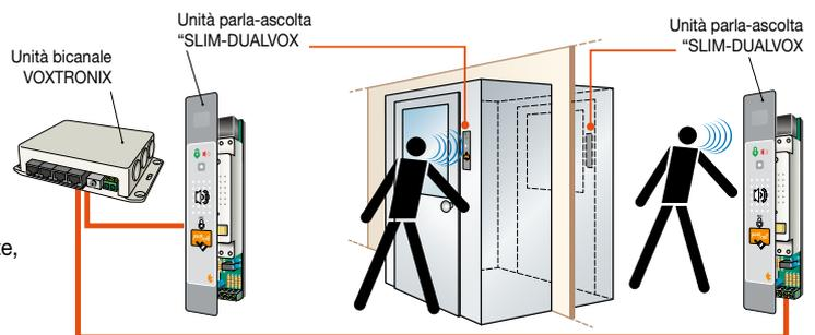
Fig. 1 - Voxtronix in configurazione BASE
